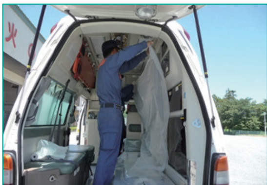
⑤上部から取り外し開始(天井部から) シートは内側に丸めながら収納
